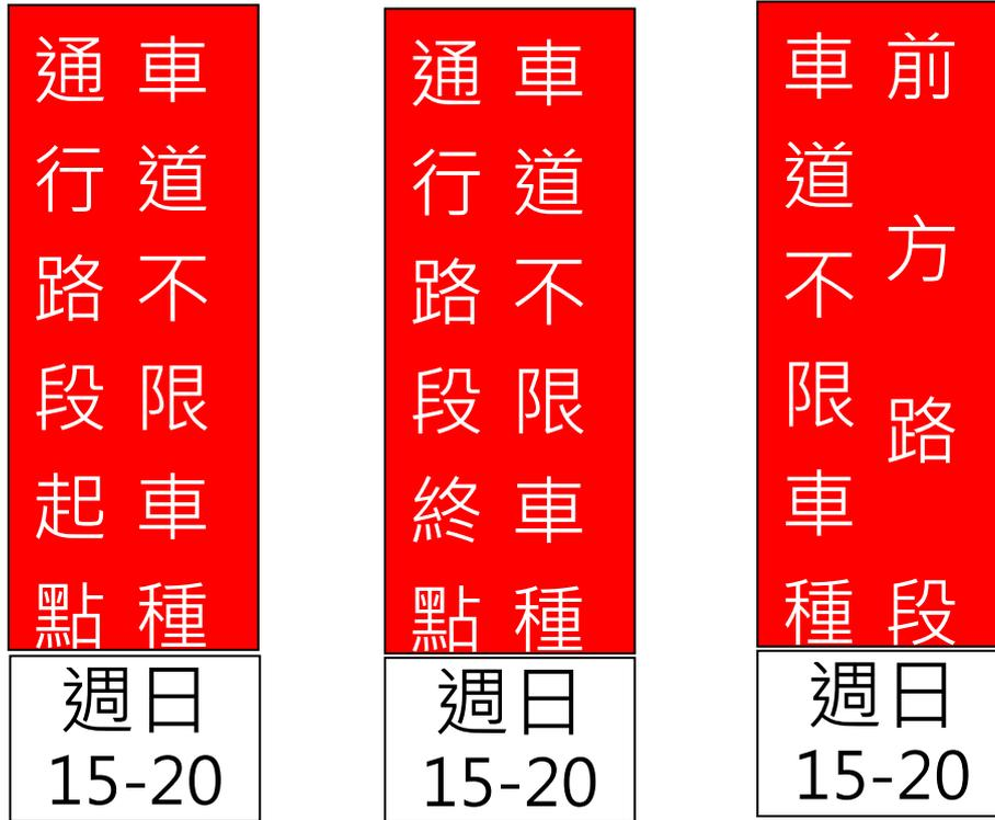
圖 2 國 5 北向石碇-南港系統「車道不限車種通行」牌面內容示意圖
