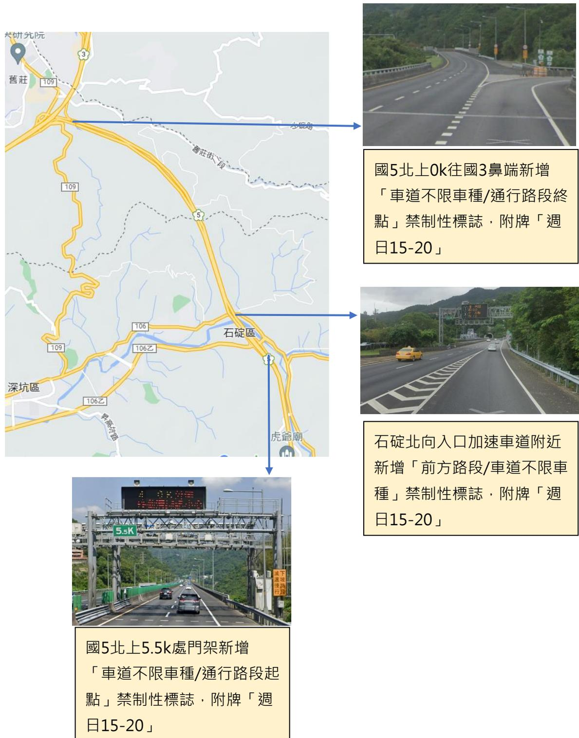
圖 1 國 5 北向石碇-南港系統「車道不限車種通行」牌面位置示意圖
